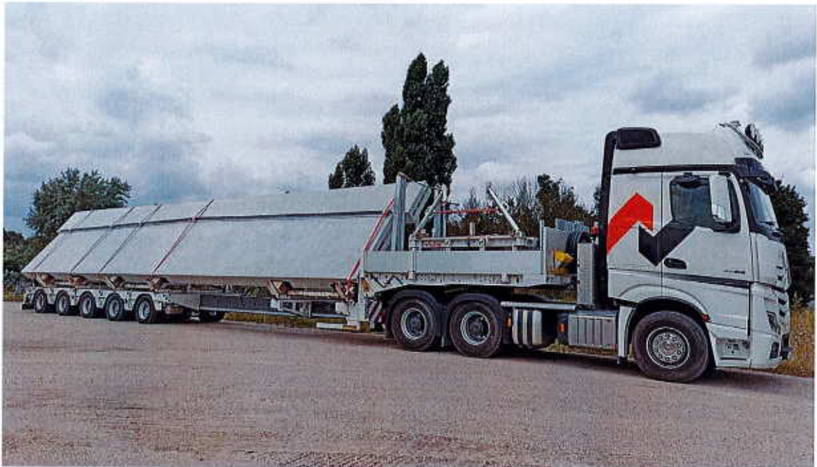
Transport von Wandplatte auf der Straße.
